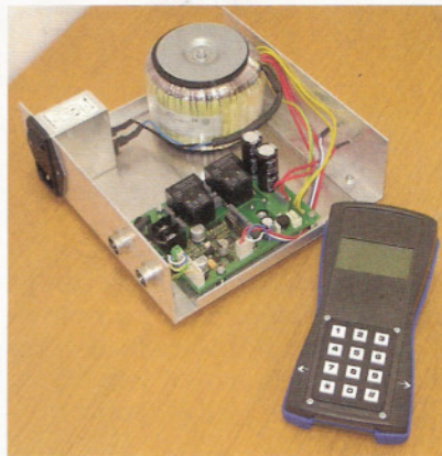
Obr. 5. Řídicí elektronika a ovladač rotátora RAK SPID
